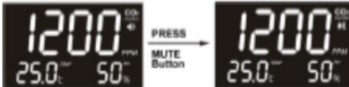
Mute - Taste zum Aktivieren des Alarmtons drücken. Bei aktivierten Alarmton erhöht bei Erreichen von 1200ppm der Buzzer. **Hinweis:** Nachdem erstmaligen Einschalten ist Alarm aktiviert
